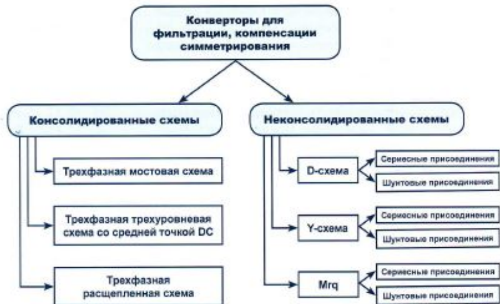
Рис. 8. Классификация конверторов, предназначенных для фильтрации, компенсации, симметрирования
